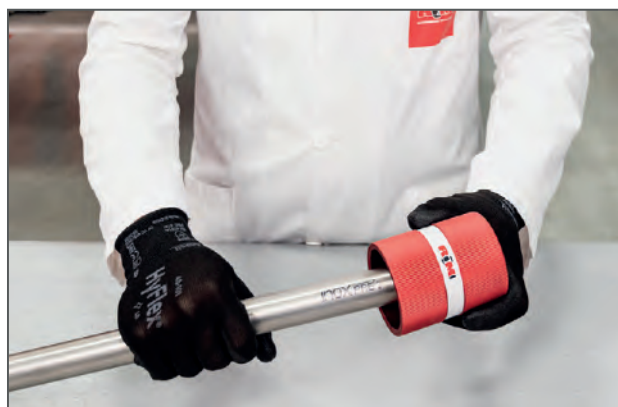
Sbavatura del tubo / Deburring the pipe
