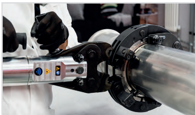
Assemblaggio pressatura n°1 / Press assembly phase 1
