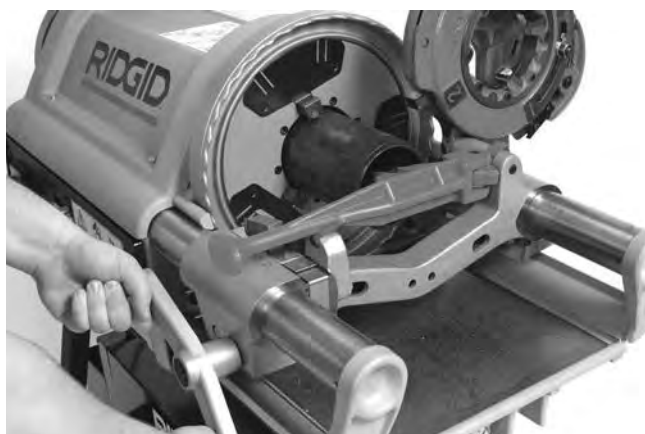
Figura 22 – Alesatura del tubo con l'Alesatore
