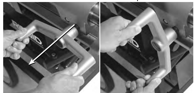
Figura 20 – Regolazione del volantino del carrello
