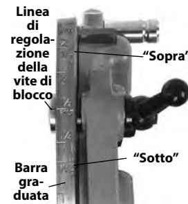
Figura 10 – Regolazione della dimensione della filettatura
