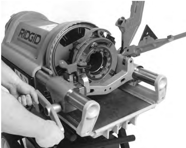
Figura 23 – Filettatura del tubo (Testa portapettini 714 mostrata)
