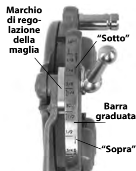
Figura 6 - Regolazione della dimensione della filettatura
